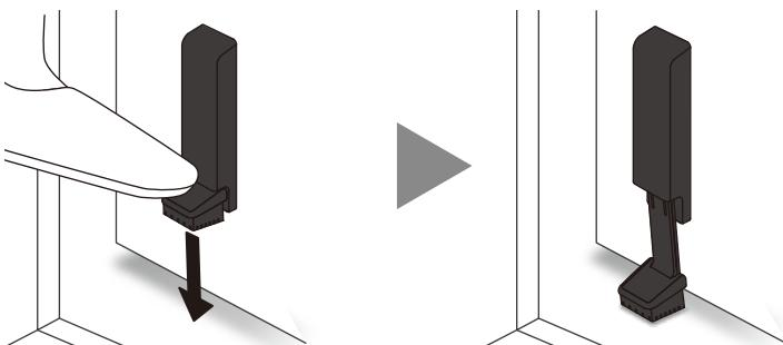
○止まらない場合は、更にペダルを強く踏み込んでください。○踏み込んでも止まらない場合は、再度、設置条件に合ったドアかご確認ください。その後、取り付け位置を調整してください。○ゴム製のサンダル・長靴等のつま先では踏みづらく感じることがあります。○ペダルを踏みながら意図せず手や肩等でドアを押してしまい、ペダルが固定されない場合があります。○踏み込む際に、本体がドアから浮いてしまう場合は、設置位置を少し上に調整してください。
