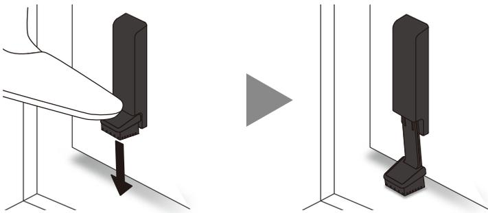
○止まらない場合は、更にペダルを強く踏み込んでください。○踏み込んででも止まらない場合は、再度、設置条件に合ったドアかご確認ください。その後、取り付け位置を調整してください。○ゴム製のサンダル・長靴等のつま先では踏みづらく感じることがあります。○ペダルを踏みながら意図せず手や肩等でドアを押してしまい、ペダルが固定されない場合があります。○踏み込み際に、本体がドアから浮いてしまう場合は、設置位置を少し上に調整してください。
