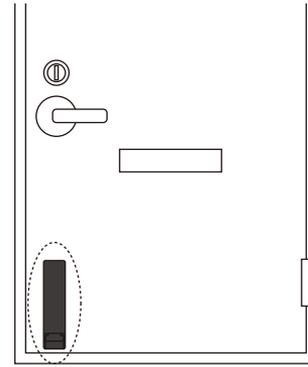
ドアを開けた状態でペダルのゴム下と固定する地面のすき間3~7cmの範囲に取り付けてください。
