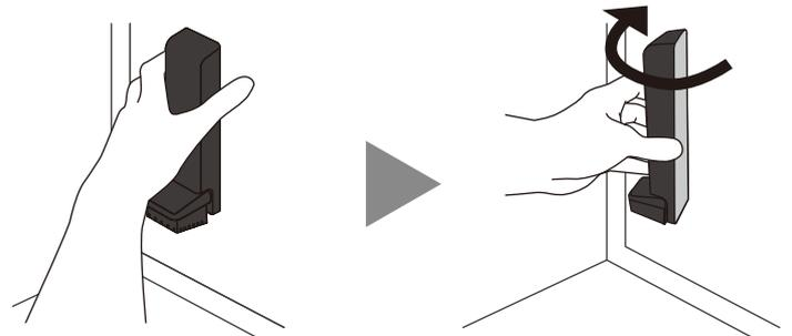
○本体をスライドさせたり、ペダルを持って引っ張らないでください。ドアを傷付けたり製品の破損に繋がります。
