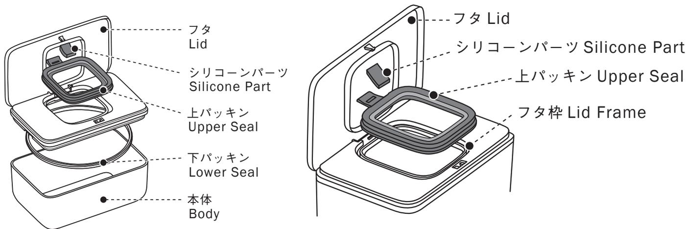
① フタ枠の内側に上パッキンを挟み込むように全周取り付けます
